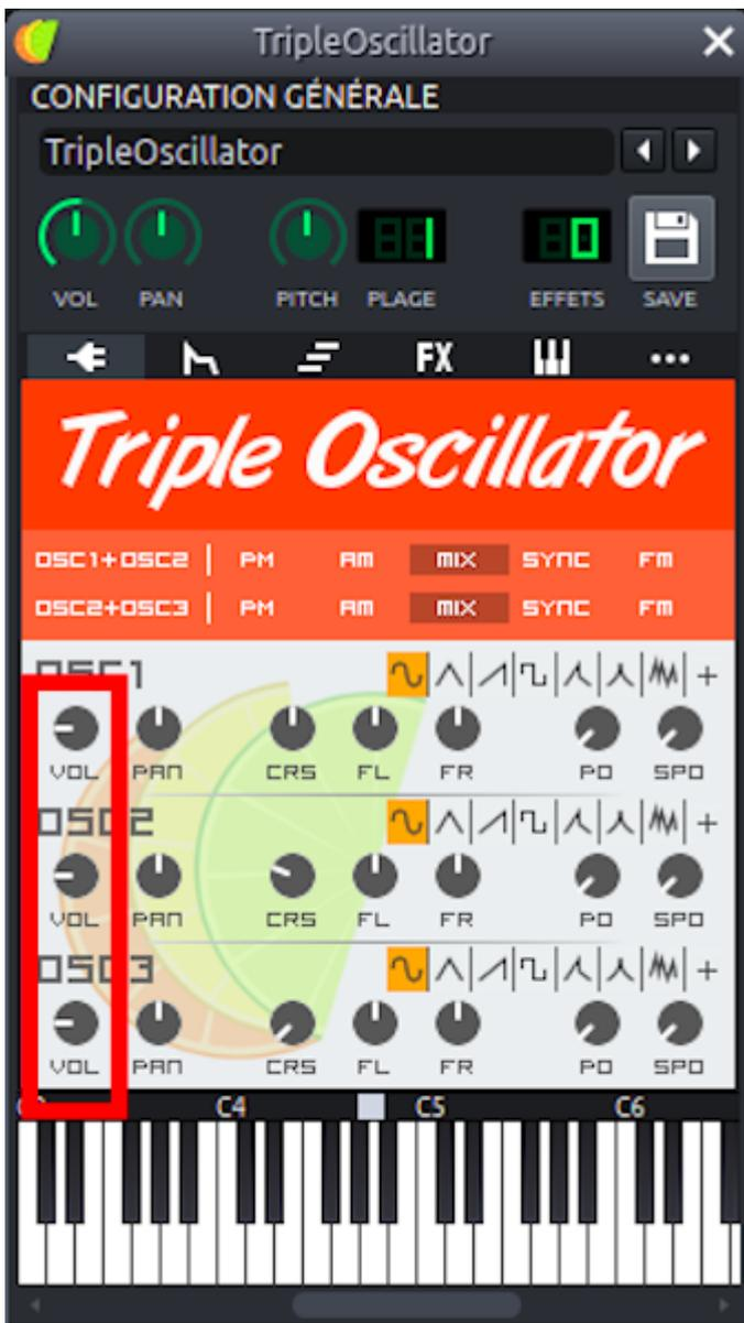
Les petits boutons en haut à droite de l'oscillateur permettent de **définir sa forme d'onde**. Essayez les pour expérimenter les différents sons que ces ondes produisent.
