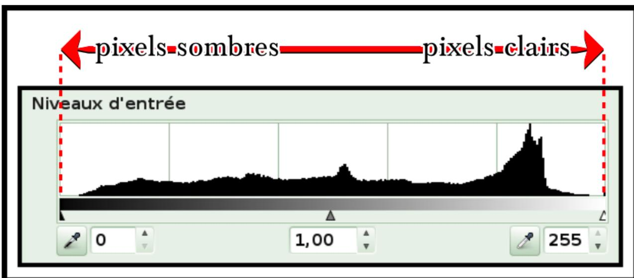
Comme vous pouvez le voir, un tableau en deux dimensions classe le nombre de pixels en fonction de leur niveau de luminosité. Nous pouvons voir, à gauche, qu'il n'y a aucun pixel totalement noir, à droite qu'il n'y a aucun pixel totalement blanc, et également un pic situé à droite, qui correspond dans ma photo au mur en arrière-plan.
